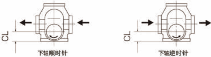
CJH型安装方式和液体流向
